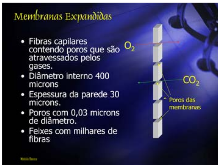
Figura 8.5. Mostra os poros das membranas capilares e os gases passando por eles. Não tem semelhança com a difusão nas membranas verdadeiras. Ainda assim, a diferença de pressão parcial dos gases nos dois lados do capilar preside as trocas gasosas.
